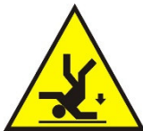
Segnaletica di pericolo: caduta dall'alto
