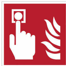
Pulsante di allarme antincendio
