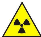
Segnaletica di pericolo: radiazioni ionizzanti
